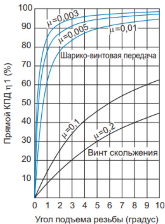
Рис. 1. Зависимость КПД винтовых механизмов от угла подъёма винтовой линии
